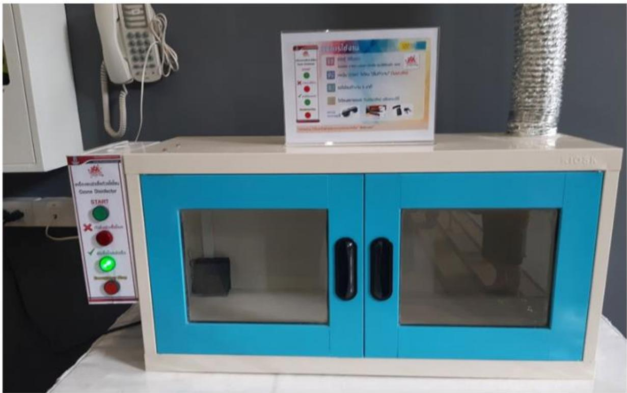
สำหรับการออกแบบและสร้างเครื่องอบฆ่าเชื้อด้วยกําขิโอนดังกล่าว มีหลักการออกแบบคำนึงถึง 2 ส่วนสำคัญ คือ โอดิโอนมีสถานะเป็นกําขิโอนพิเศษต้องเลือกเครื่องอบที่เป็นระบบบีปิดเพื่อให้สามารถถักเก็บและป้องกันการรั่วไฟล์กําขิโอน โดยเครื่องอบฆ่าเชื้อที่พัฒนาขึ้นมีความสามารถในการอบฆ่าเชื้อด้วยเวลา 2 นาที ที่ความจุ 20 - 100 ลิตร ความเข้มข้นของกําขิโอนมีค่าสูงกว่า  $2.5 \text{ ppm}$  ซึ่งเพียงพอสำหรับการฆ่าเชื้อไวรัส
